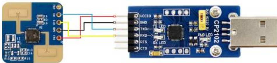
图 4-1 HLK-LD2420 硬件与 USB 串口转接板的连接方式
